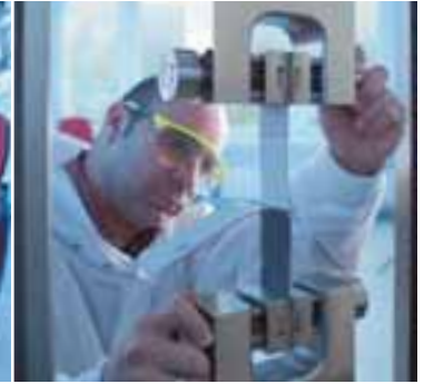
Schälprüfung mit geschweisster Kunststoffprobe.
